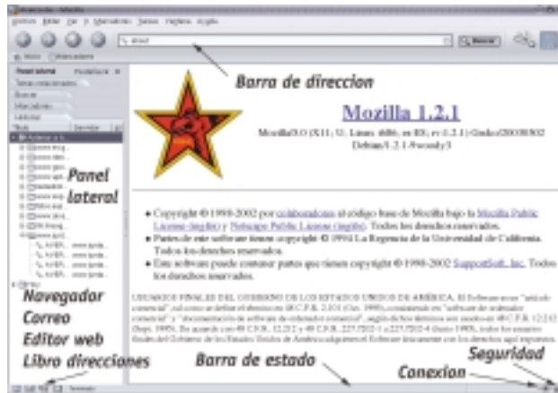
Figura 3.2: Elementos de las ventanas de Mozilla.
